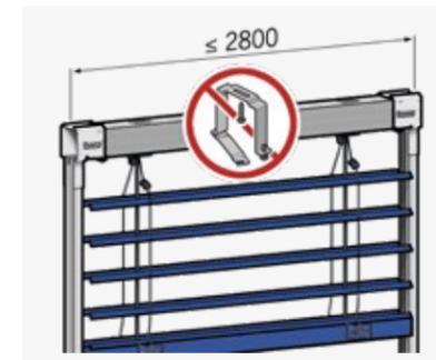
El sistema de persianas autoportante protege el aislamiento del dintel y minimiza los costes de servicio. Hasta un ancho de 2800 mm, el sistema no necesita fijación para el puente. El aislamiento permanece intacto y se reduce la transmisión de ruido.
