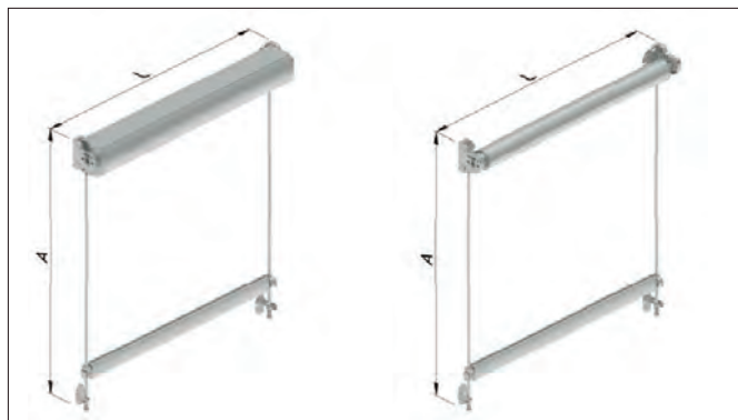
medición de sistema con cofre
